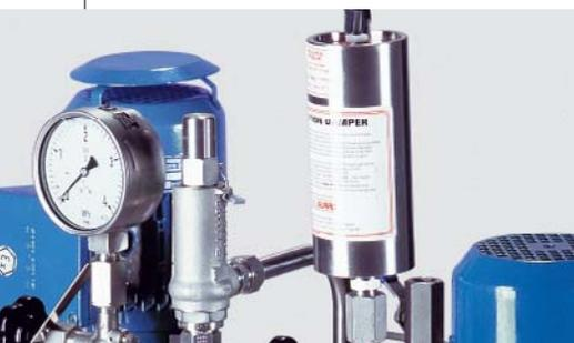
Внешний предохранительный клапан
